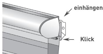
Montageprofil des Doppel-Rollos oben in die Befestigungsclips einhängen und unten mit leichtem Druck einklicken.
