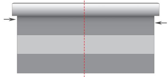
Im hinteren Montageprofil muss sich der Stoff in zentrierter (mittiger) Position befinden, damit sich der Stoff gerade auf der Welle aufrollt. Ansonsten kann es beim Aufrollen zu einer Beschädigung des Textils kommen.
