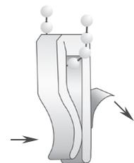
Schutzfolie entfernen und Kettenhalter in gewünschter Position am Fensterrahmen befestigen
