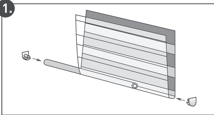
**1.** Beschwerungsstab in das leicht abgerollte Doppel-Rollo einlegen und die Endkappen zur Fixierung seitlich in den Beschwerungsstab einstecken.
