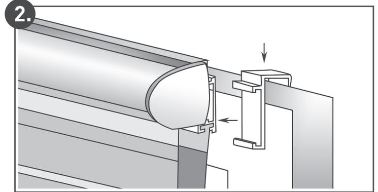
**2.** Klemmträger seitlich auf das Montageprofil aufschieben, Schutzfolie des Klebestreifens abziehen und auf dem Fensterrahmen einhängen.
